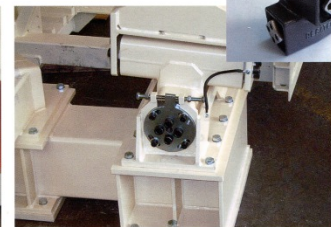
Universal oscillating unit on a gyratory sifter 通用避震接头在旋转式振动筛上的应用
