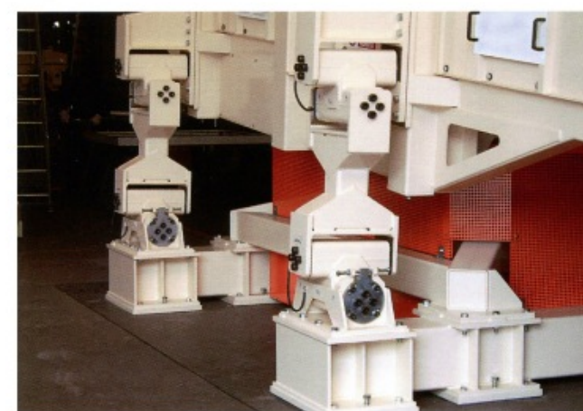
Universal oscillating unit on a gyratory sifter 通用避震接头在旋转式振动筛上的应用
